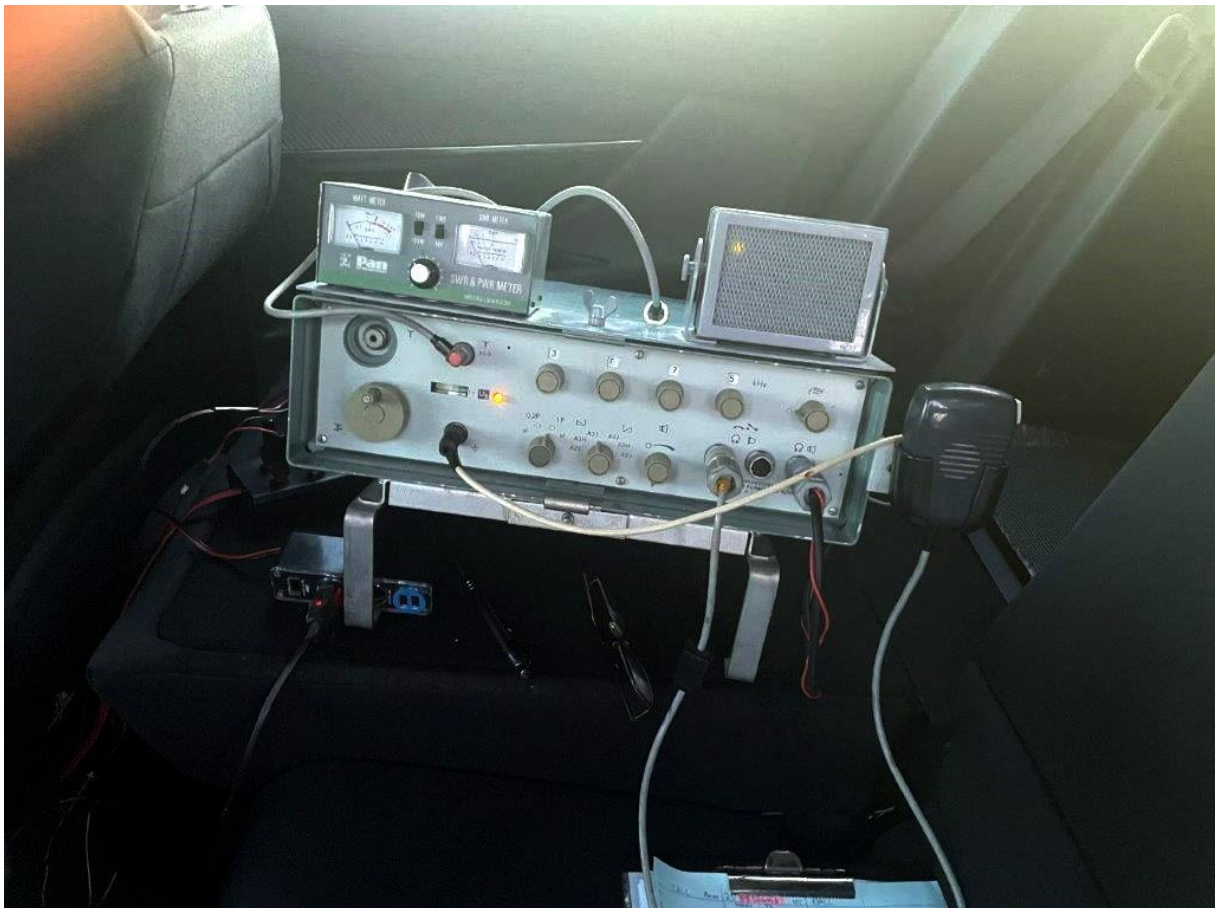
RIG: SEG-15D im Portabeleinsatz
