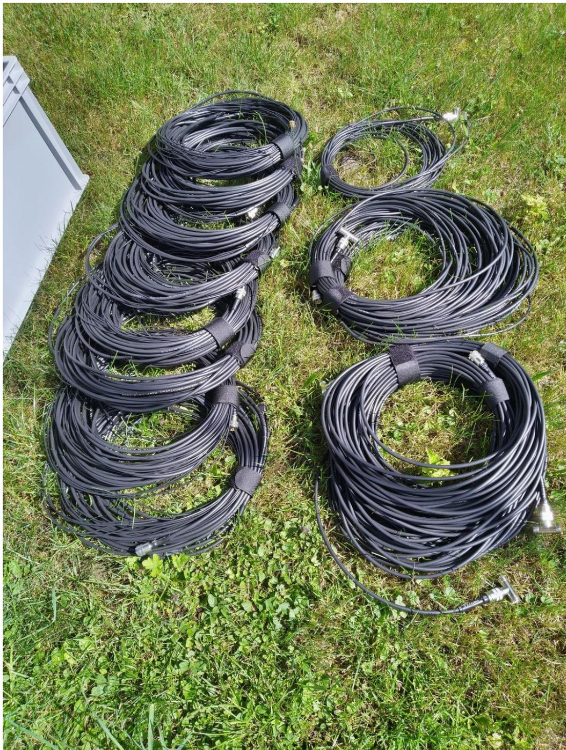
Bild: Fertige Antenne: 8 Strahler plus Koaxialtransformatoren
