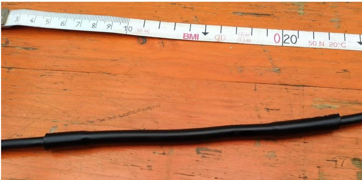
An der Seite der Einspeisung 2 Gegengewichte (1,5 qmm Schaltlitze) von jeweils 6 Meter Länge an Schirm anlöten und ebenfalls mit Schrumpfschlauch überziehen.
