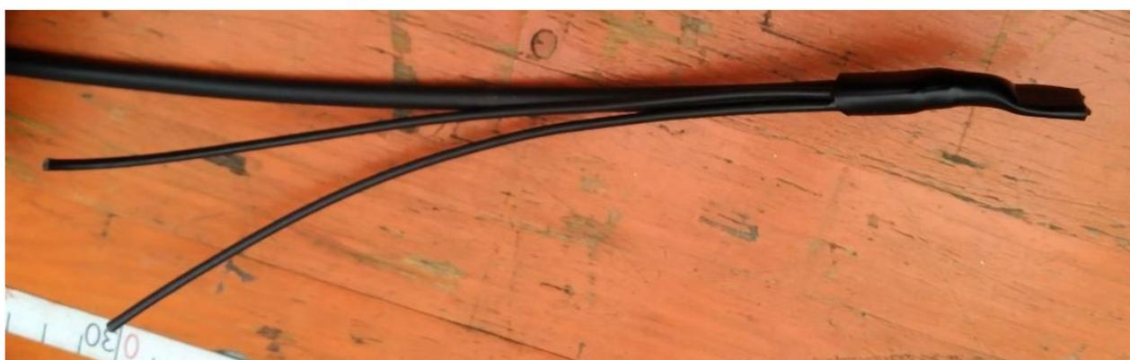
Dann an den bemaßten 4 Stellen auf 10 cm Schirm entfernen und mit Schrumpfschlauch überziehen.
